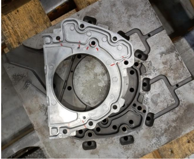
1.ábra Az alumínium nyomásos öntőszerszám és gyártmánya
