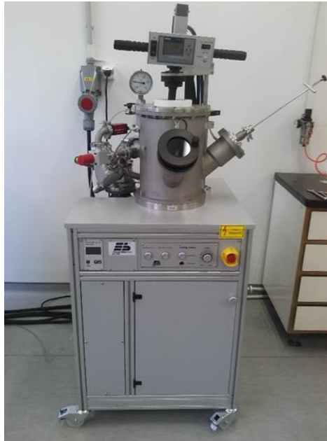
2. ábra Arc Melter 500 ívsugaras átolvasztó berendezés
