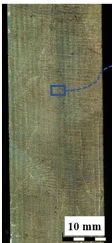
3. ábra. Az Al 6082-T6 próbatest felületének részlete
