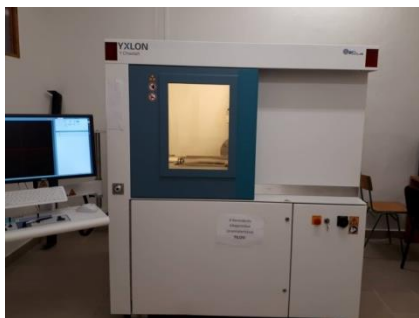
1. ábra Y. Cheetah FXE 160.51 típusú multifókuszú röntgen berendezés, áttekintő kép a berendezésről (balra), vizsgáló kabin (jobbra)
