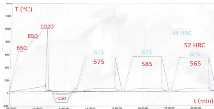
8.ábra A végső hőkezelési diagram jellegzetes hőmérsékletekkel, valamint szétválasztott keménységekkel (kék: mozgó oldal; piros: álló oldal)
