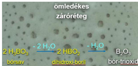
8. ábra: Ömledék képződése bórsavból 9
