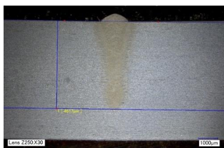
1. ábra Lézerhegesztett 34MnB5-4 jelölésű minta a)fénymikroszkópos felvétele Neredeti=30 \times b) lézerhegesztés keménységtérképe, mintavételi távolság 0,5 mm
