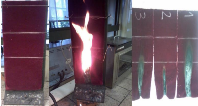
6. ábra: Égéskésleltetett textilá szabványos vizsgálati minősítése 7
