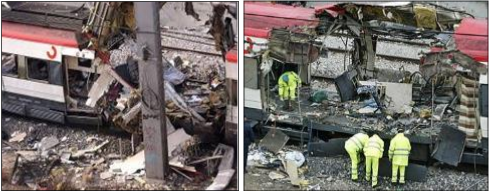
1.ábra A robbantás hatása a szerelvény elején és a végén [4]
