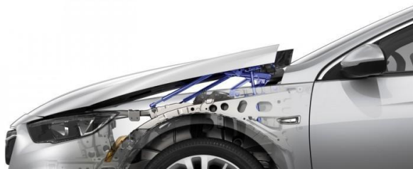
3. ábra General Motors Active Hood felépítése [11]
