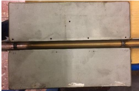
3. ábra Összefűzött próbatest a termoelemeknek előkészített furatokkal
