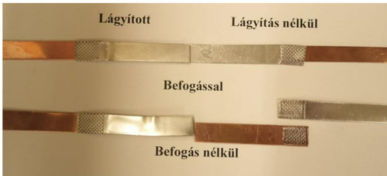
2. ábra Befogással és befogás nélkül hegesztett darabok
