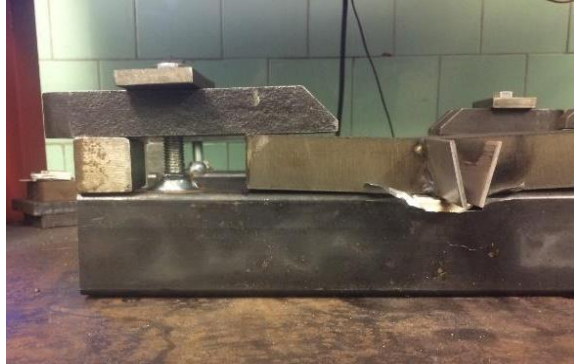
5. ábra MIG eljárással való hegesztés után elhajlott darab és készülék
