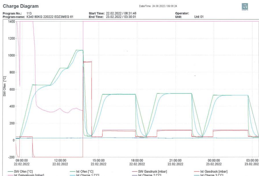
2. ábra A 80kg-os szerszám hőkezelési diagramja
