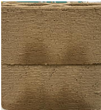
7. ábra - Alul 20 mm, felül 16 mm átmérőjű extruderfejjel nyomtatott rétegek
