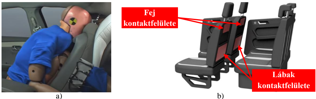
3. ábra. a) a hátsó ülésor utasának jellemző baleseti becsapódási régiói; b) egy reprezentatív 3D CAD környezetben kijelölt fejlesztési területek.
