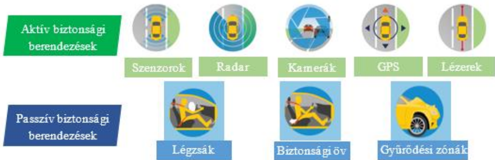
1. ábra A járművekben elterjedt aktív [3] és passzív [4] biztonsági berendezések.
