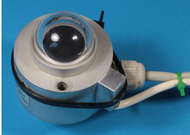
3. ábra. A piranométer előkészítése
