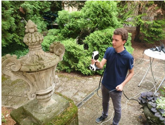
3. ábra. Sérült homlokzati elem szkennelése SCANTECH iReal 2E Color kézi 3D szkennerral
