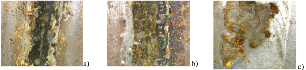
3.ábra - 1,5mm vastagú lemez varrat környezetének megjelenése 72 óra korróziós tesztelés után,
